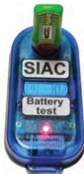
La funzionalità AIR+ della SIAC non è sempre attiva, in modo da ridurre il consumo di batteria. La funzionalità viene attivata con il punzonamento della stazione CHECK dopo la pulizia del chip, e viene spenta con la punzonatura del FINISH.
